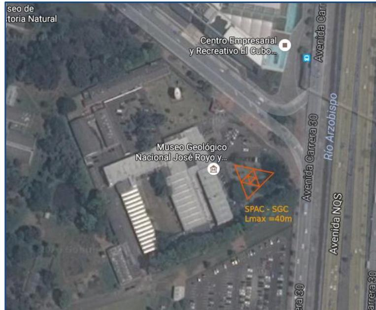
Figura 21. Ubicación del ensayo de microtremores realizado para la obtención del modelo de velocidad de onda s en la zona de estudio. Modificado de Google Earth (2016)
